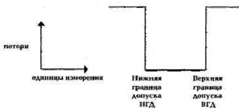
Рис. 36. Представления с помощью функции потерь Тагути подхода к управлению качеством на основе границ допусков
